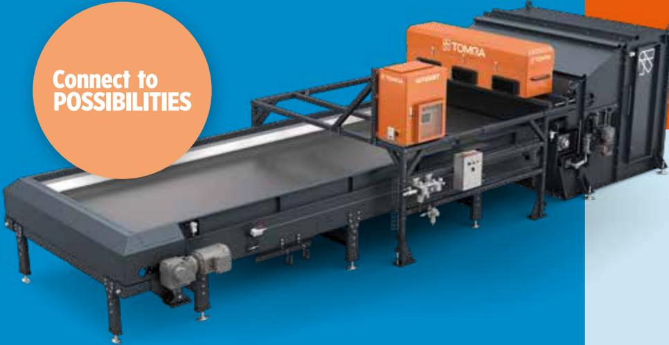
AUTOSORT™ 제품군의 하나인 AUTOSORT™ FINES 장비는 검증된 FLYING BEAM™ 기술과 고속 에어 토출 밸브를 기반으로, 다양한 혼합 물질에서 미세한 입자의 고순도 플라스틱 선별에 특화된 솔루션을 제공합니다. FLYING BEAM™ 기술은 외부 광원 램프를 제거하여 먼지와 오염으로부터 보호되며, 낮은 운영 비용 및 운영 시간을 극대화하는 것이 가능합니다.
